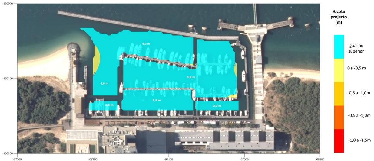
**Figura 23.** Marina de Troia: Batimetrias (26/01/2023) em relação aos valores de projeto. A azul, profundidades iguais ou superiores às de projeto; amarelos a vermelhos, perda de batimetria em relação às batimetrias de projeto. (Sistema PT-TM06/ETRS89, sobre ortofotomapa do Território, de 2018).
