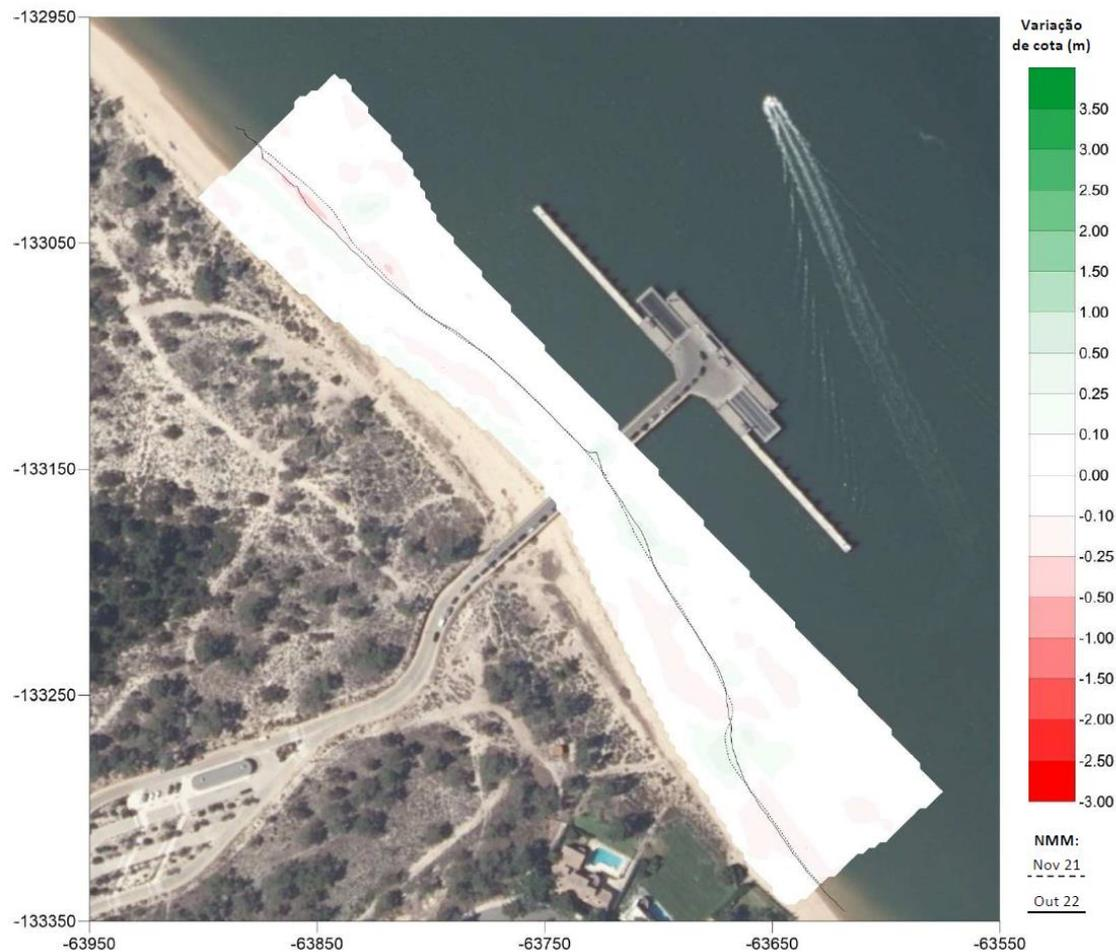
**Figura 22.** Variações volumétricas no trecho costeiro envolvente do novo cais dos *ferries*, com a linha de costa (nível médio do mar - NMM) sobreposta: Outubro de 2020 (linha tracejada); Novembro de 2021 (linha contínua). (Sistema PT-TM06/ETRS89, sobre ortofotomapa do Território, de 2018).
