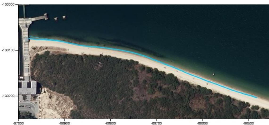
Figura 17. Troço costeiro a montante da Marina de Troia com a linha de costa (nível médio do mar - NMM) sobreposta: outubro de 2020 (linha azul contínua) e Setembro de 2019 (linha azul tracejada).
