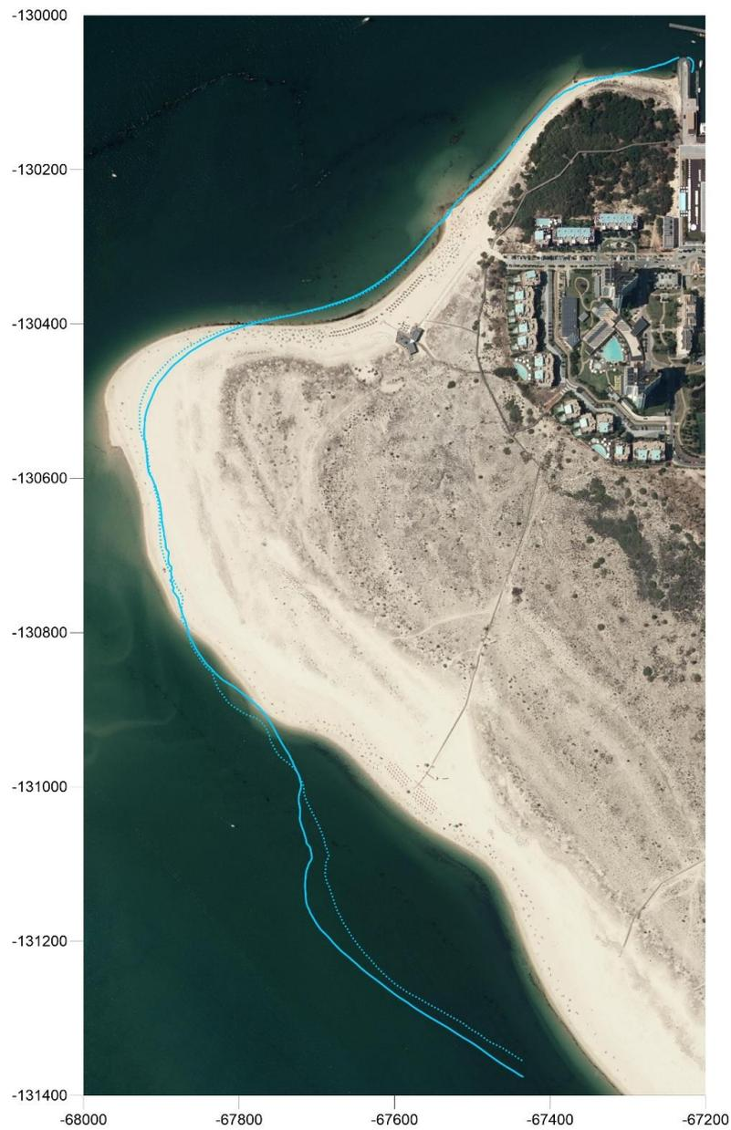
Figura 16. Vértice NO da península de Troia com a linha de costa (nível médio do mar - NMM) sobreposta: outubro de 2020 (linha azul contínua) e setembro de 2019 (linha azul tracejada).
